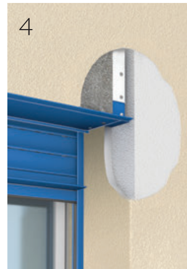
4 Задел откосов. Ревизионная крышка короба крепится к боковой крышке. Для смещения на толщину оштукатуренного слоя (не более 25 мм от торца крышки) устанавливаются пластины SB-I/PL.
